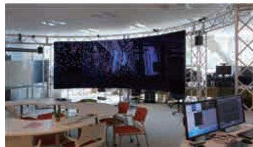
15面シリンダリカル立体表示システム (グランフロント大阪9Fうめきた拠点)
